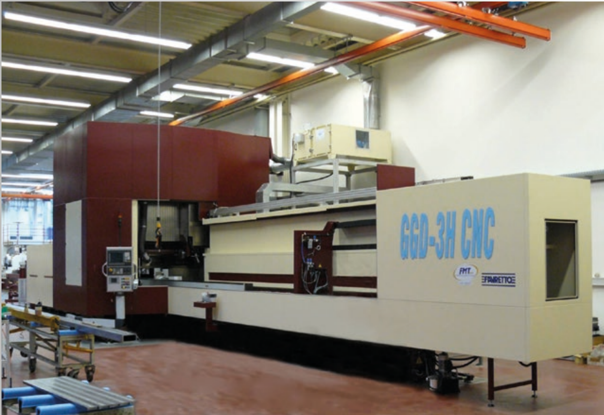
Тяжёлые порталные станки с жёсткой поперечиной для шлифования линейных шариковых и роликовых направляющих.
